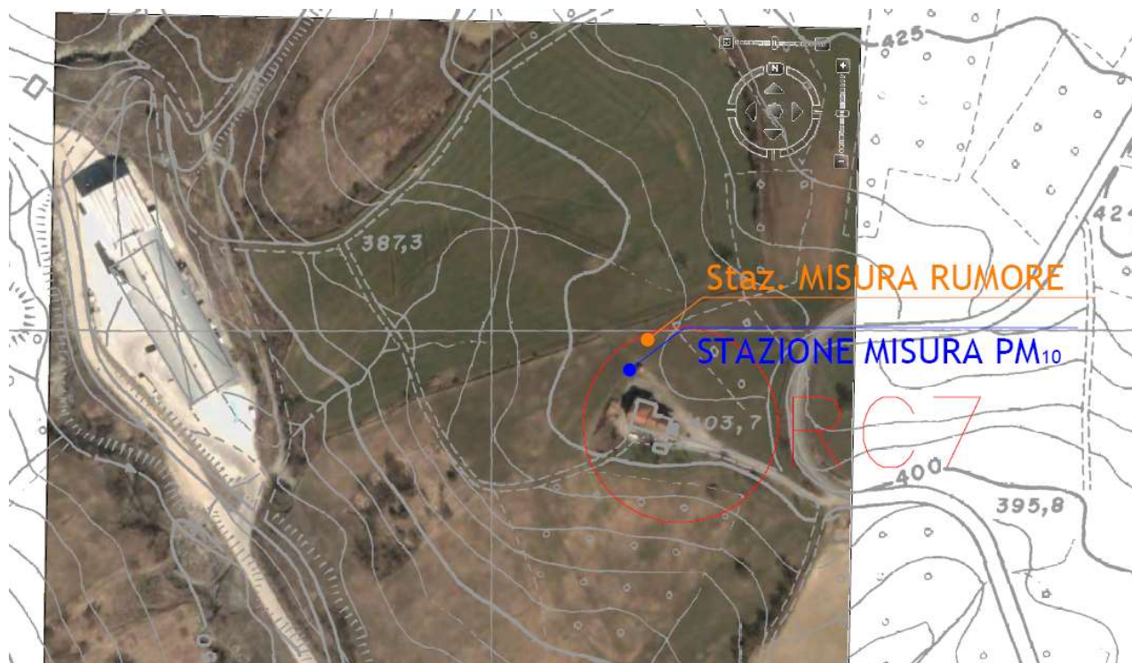
Figura 8. Ubicazione stazione di misura STZ1 (RC 7)
