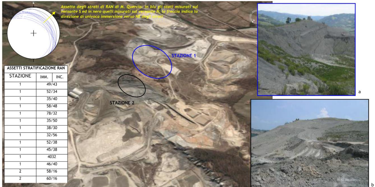
Fig. 4 - Visione panoramica della zona di cava, posizionamento delle aree interessate dall'indagine strutturale (immagine da Google Earth) e proiezione stereografica dell'andamento degli strati; a - particolare della zona di indagine Stazione 1; b - particolare della zona d'indagine Stazione 2
