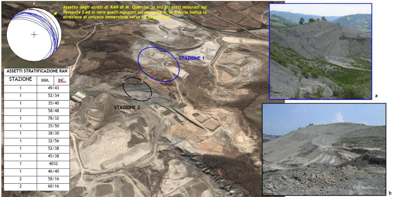
Figura 7. Visione panoramica della zona di cava, posizionamento delle aree interessate dall'indagine strutturale (immagine da Google Earth) e proiezione stereografica dell'andamento degli strati; a – particolare della zona di indagine Stazione 1; b – particolare della zona d'indagine Stazione 2. Estratto dalla relazione geologica del precedente PCS della cava Braglie.
