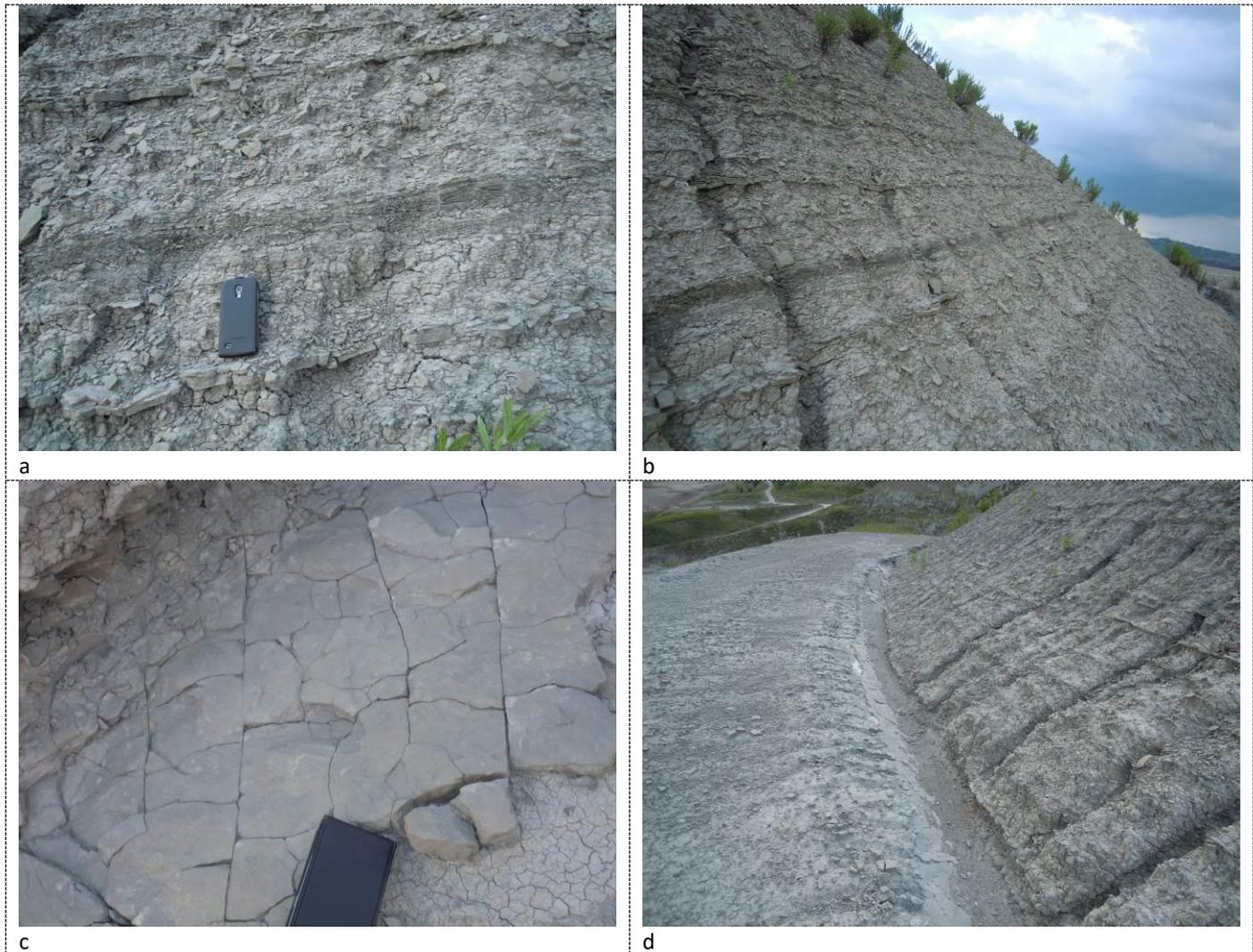
Figura 26. Assetto strutturale tipico nella zona di confine tra le cave M.te Quercia e Molino di Canevarola. Giacitura 35-40° con disposizione reggipoggio e leggero traversa poggio. In c) livello arenaceo spessore 3-4 cm disposto a reggipoggio con fatturazione k1 ortogonale alla giacitura e sistema trasversale a k1 (k2) ad andamento non lineare. Le superficie di strato presentano ondulazioni laterali. Il rapporto A/P in tale sezione è circa 1/4 - 1/5 (in a: 14 cm/60 cm).
