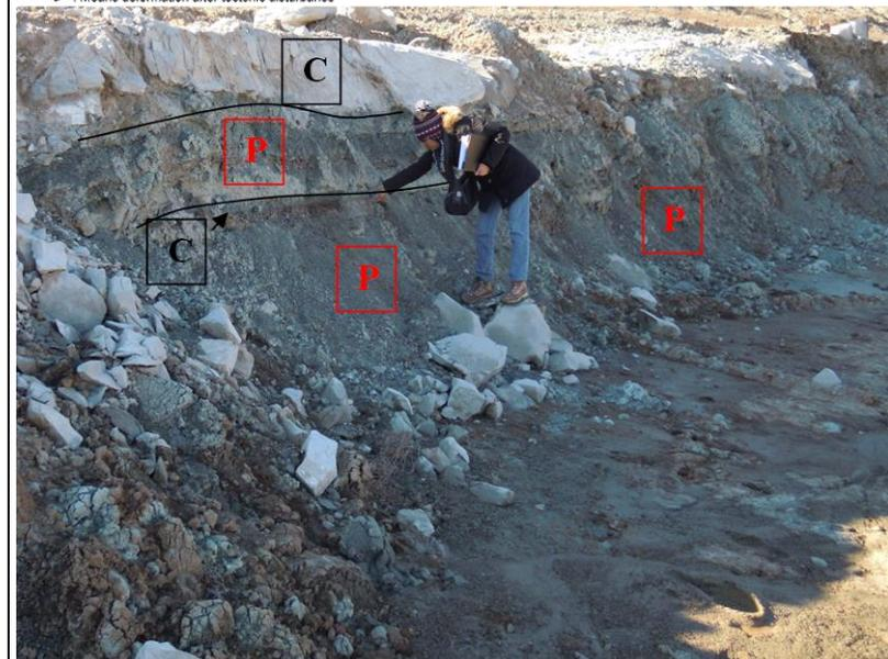
Figura 29. Sezione MMP. Altezza fronte = 2.0 m. Calcari n. 2 strati per un totale di 0.5 m (0.4+0.1). Rapporto A (o C = calcari)/P (Peliti = Argilliti) = 1/4. Sezione tipo tetto MMP al contatto con RAN. Nelle restanti porzioni il rapporto A/P risulta anche inferiore a 1/10 (vedi fotografie successiva).
