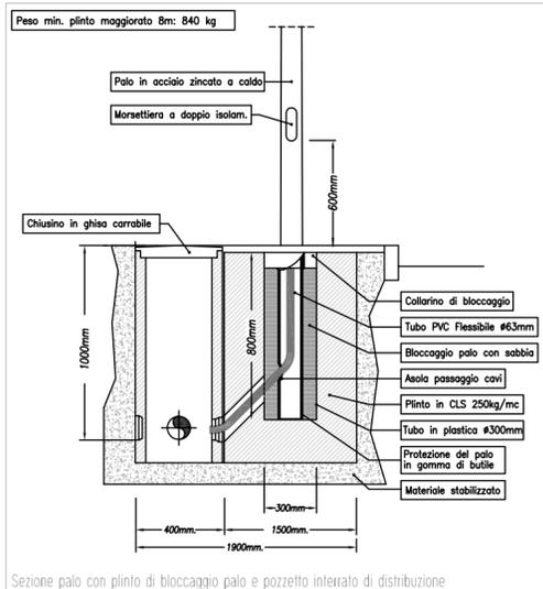
Sezione palo con pianto di bloccaggio palo e pozzetto interrato di distribuzione
